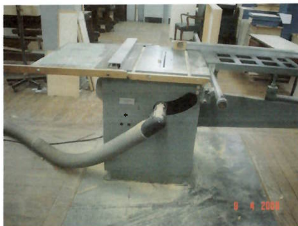
Figura 23 - Serra com aspirador de pó acoplado
