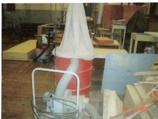
Figura 24 - Detalhe do recipiente para armazenar poeira
